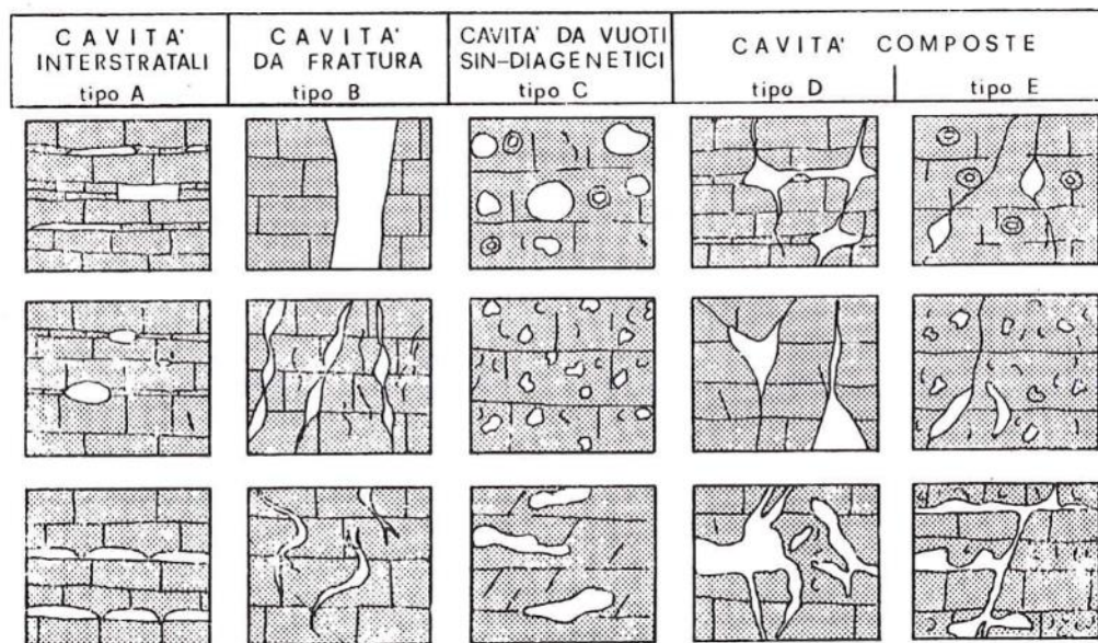
Fig. b – Principali tipologie delle cavità carsiche presenti nel sottosuolo (da F. Zezza 1977).
