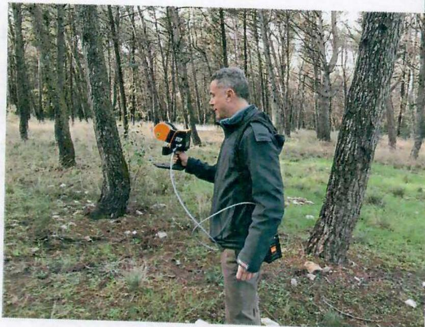
Foto n. 4 e 5 - Il Mobile Laser Scanner (Zeb Horizon - GeoSlam) utilizzato durante i rilievi.
